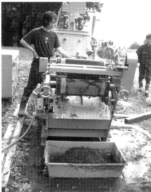
写真-1 脱水機で製造される底泥脱水土
