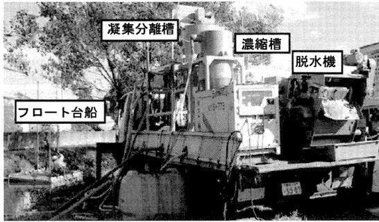
写真2 トラック積載型浚渫システム外観
