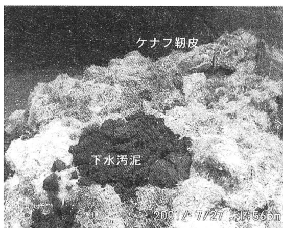
写真2 ケナフ靱皮破砕物と下水汚泥の混合
