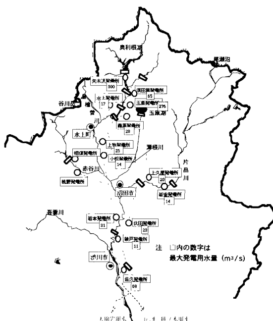
図4 利根川上流部の発電用水系統図
