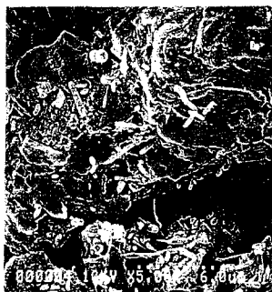
図13 粉末活性炭表面のSEM写真
