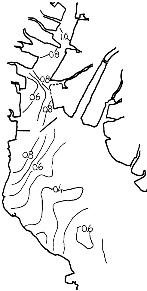
図 6 原型のSi分布(水深2m) (単位 ppm)
