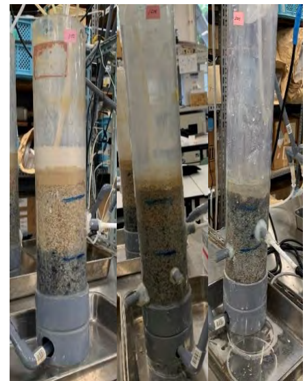
図-1 干満流と水平流を導入した人工湿地実験装置
