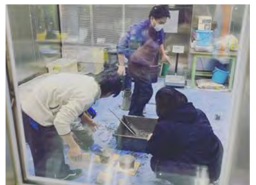
写真-2 コンクリート製造状況 (室温 10℃)
