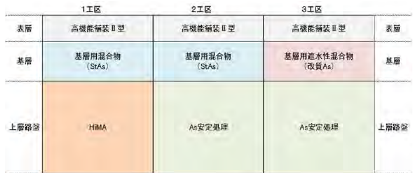
図-1 試験施工断面
