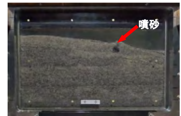
写真-1 噴砂の発生状況(ケース 3)
