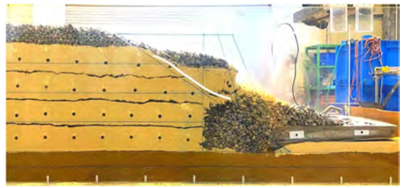
写真-1 ケース 1 加振実験終了後の模型の様子
