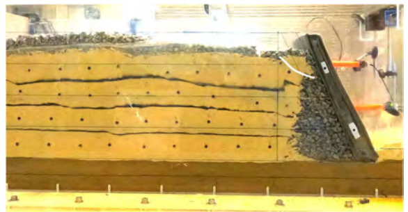
写真-2 ケース 2 1000gal 加振後の模型の様子
