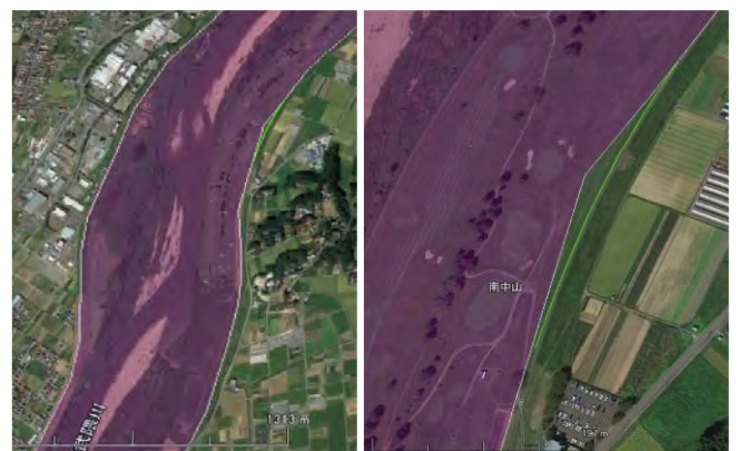
図-1 阿武隈川下流部における河道マスクと衛星画像とのずれ 左：上空 5.9km 視点，右：上空 1.0km 視点
