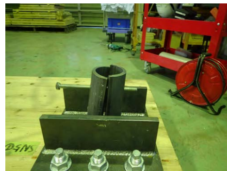
図-2 破壊後の内鞘管
