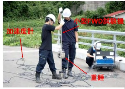
図-1 小型 FWD 試験実施状況
