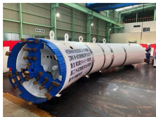
写真-1 シールドマシン中折装置状況
