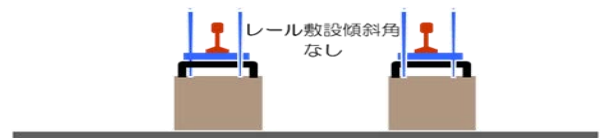
図-4 今回施工軌きょう組立後断面図
