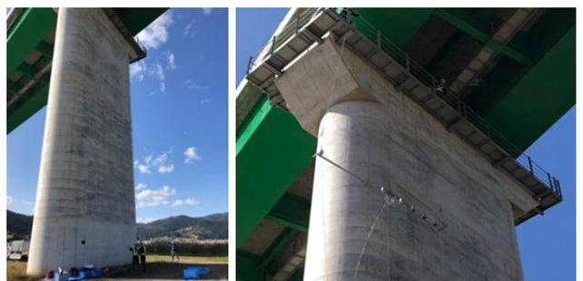
写真-8 当該点検支援装置の橋脚への適用事例
