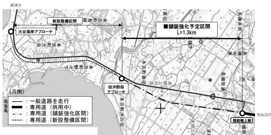
図-1：気仙沼線（大谷海岸～陸前階上間）の施工概要図 （国土地理院地図を加工して作成）
