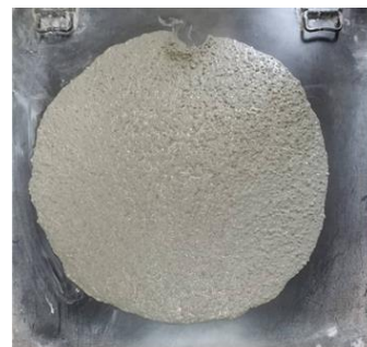
写真 1 スランプフロー試験
