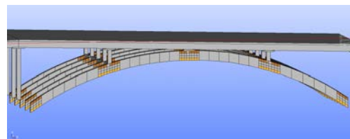
図-1 アーチ欠損腐朽箇所
