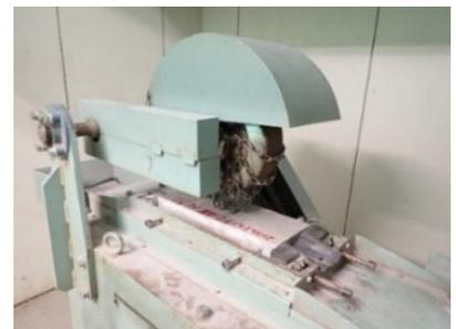
写真-1 ラベリング試験装置
