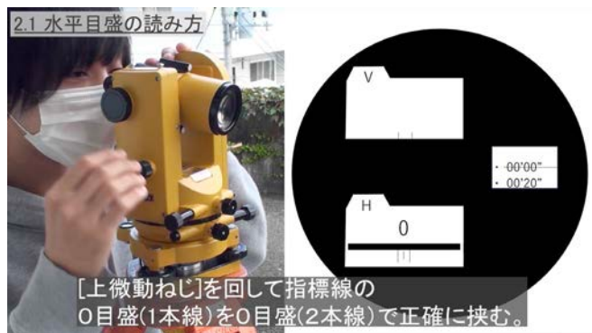
図2 視準編 0度00分00秒に合わせる
