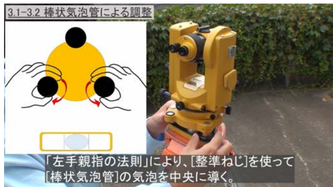
図1 据付編 左手親指の法則と棒状気泡管
