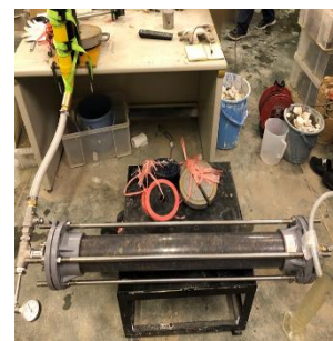
写真-2 注入装置
