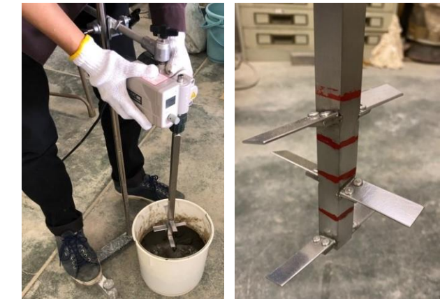
写真－1 貫入試験の様子 写真－2 攪拌翼模型
