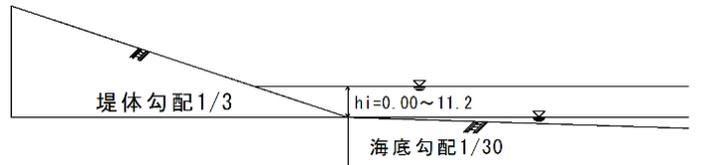
図-1 模型堤体概略図
