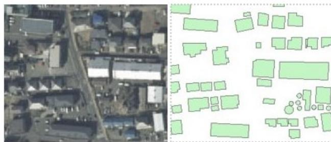
図-3 教師データの航空写真(左)と建物位置データ(右) 100棟をピックアップして分類を行い、分類の正解率を算出した結果を表-2に示す。正解率は残存建物で51.4%、流失建物で49.9%であった。
