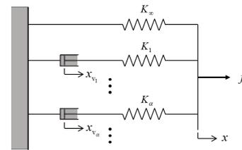
図-2 一般化 Maxwell モデル
