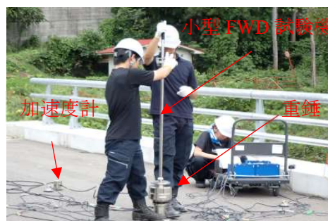
写真-1 小型 FWD 試験実施状況例
