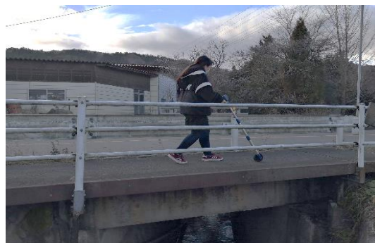
図3 橋長と幅員の計測の例
