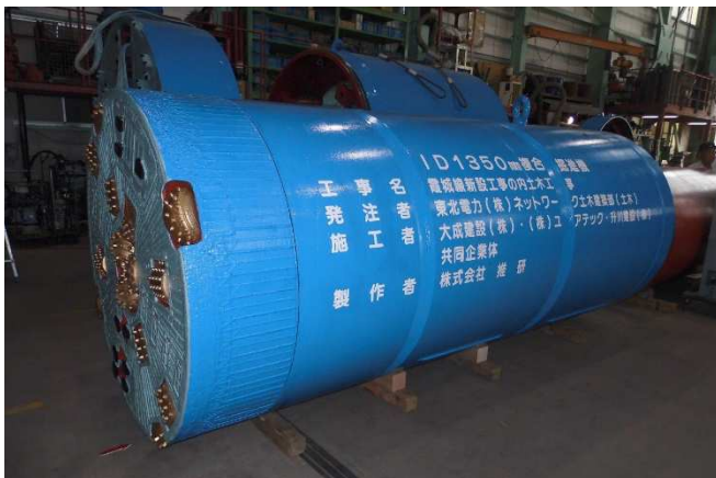
写真－１ 推進機外観状況
