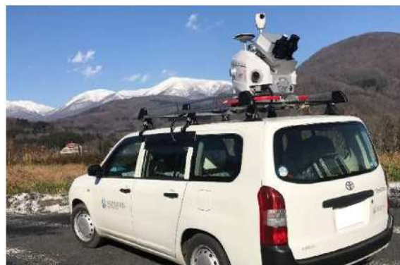
写真-1 使用した移動計測車両
