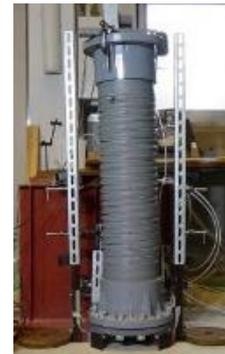
写真-1 可撓コラム載荷実験装置
