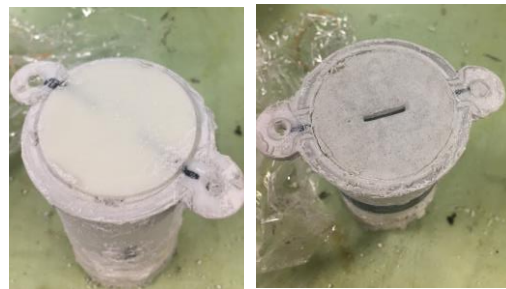
図-4 差し込み養生型
