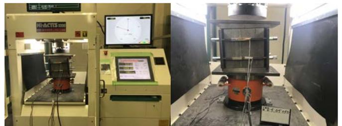
写真-2 圧縮試験機及び試験状況
