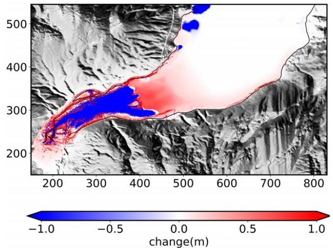
図-3 近地津波による地形変化
