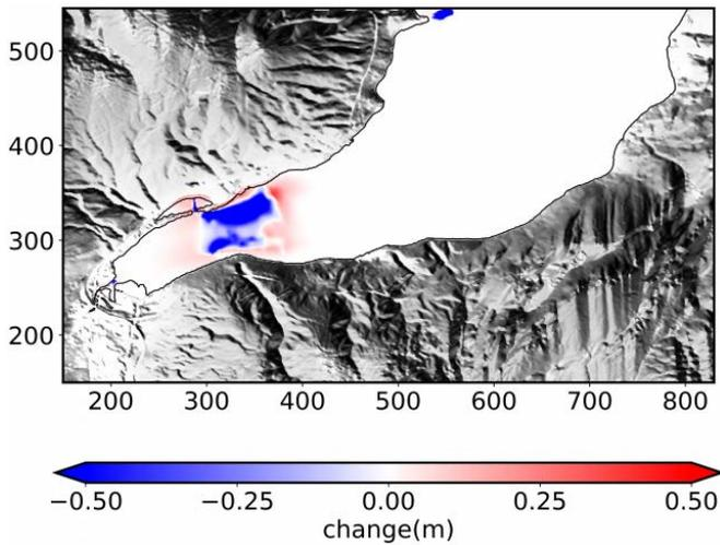
図-2 1964年アラスカ地震津波による地形変化
