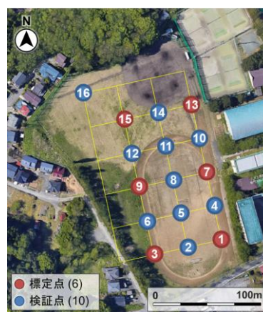
図2 標定点と検証点の配置
