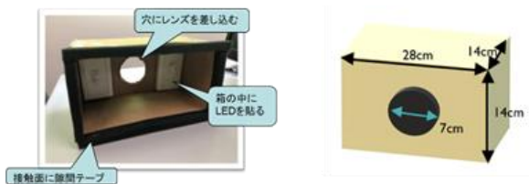
図3 撮影装置(左)と寸法(右)
