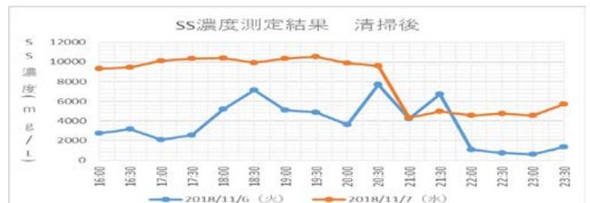
図-8 SS濃度計による測定結果(清掃実施後)
