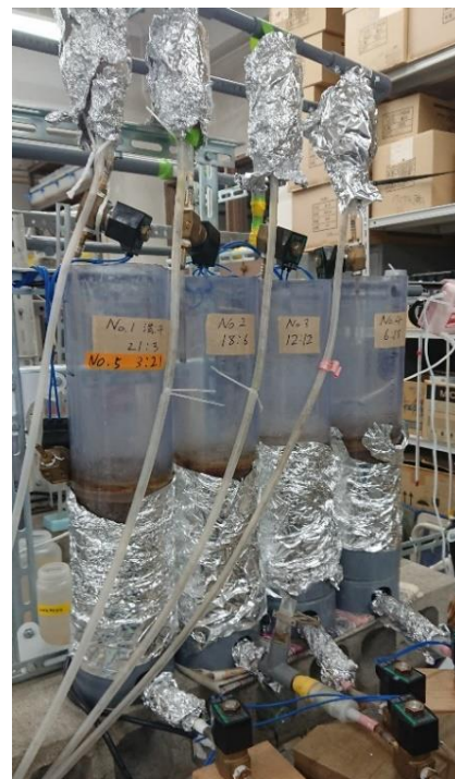
図-1 タイダルフロー人工湿地実験装置の外観
