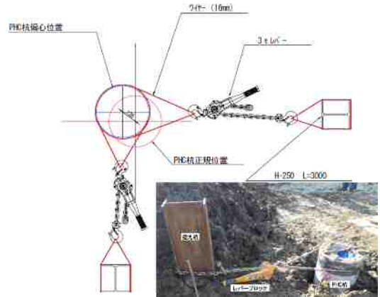
図-6 杭頭微調整設備図
