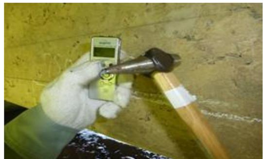
図2 打音検査の様子
