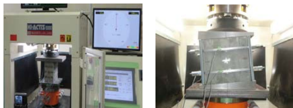
写真-2 圧縮試験機および傾斜治具による載荷試験
