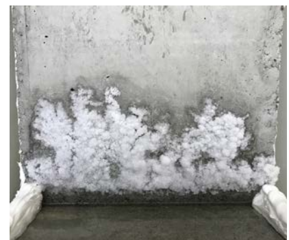
写真-1 塩水吸い上げ状況(No.1)
