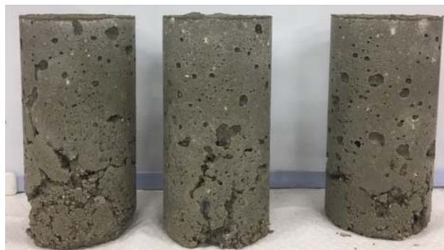
図-1 急結が生じた供試体
