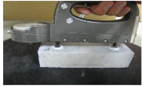
図 2 SSW モルタルバー測定
