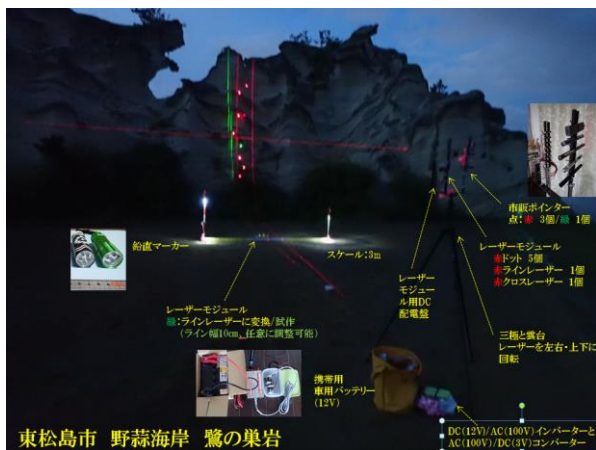
図-3 鷺ノ巣岩での多点・多線レーザー光による計測
