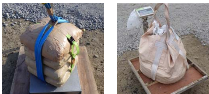
a)土のう 4 袋詰め b)トンパック詰め 写真-1 土砂模型の一例
