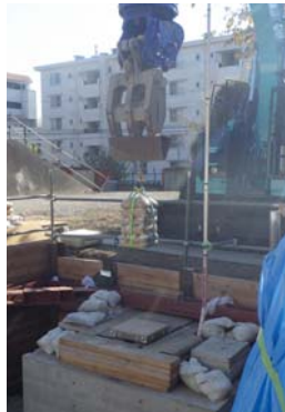
写真-3 自由落下実験の概要
