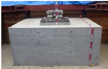
写真-2 反力壁と荷重計
