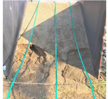
写真-3 無対策盛土の法尻崩壊状況
