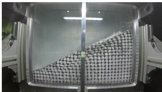
図-8 斜面の滑動状況(傾斜角 19° 時)
