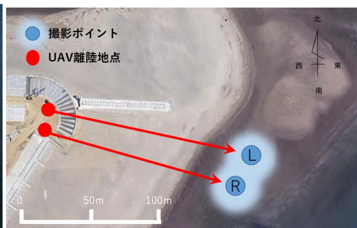
図-2 UAV 飛行ルート例
